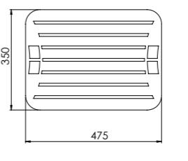
**ZZW\_X01C** INSERT -TRAY TO THE BOTTOM OF THE SINK
